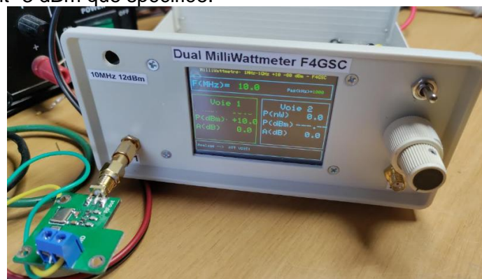
Figure 7. L'oscillateur OCXO 10 MHz fournit +10 dBm sous 50 ohms.
