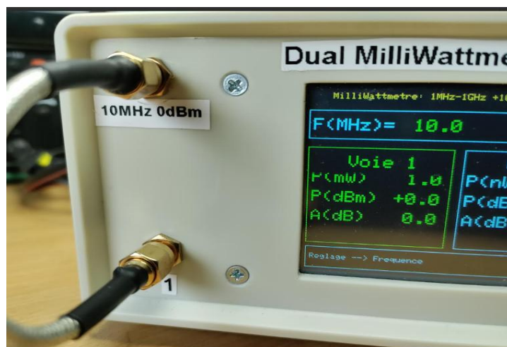
Figure 12. Après réglage, la puissance de sortie calibrée sous 50 ohms est 0 dBm.
